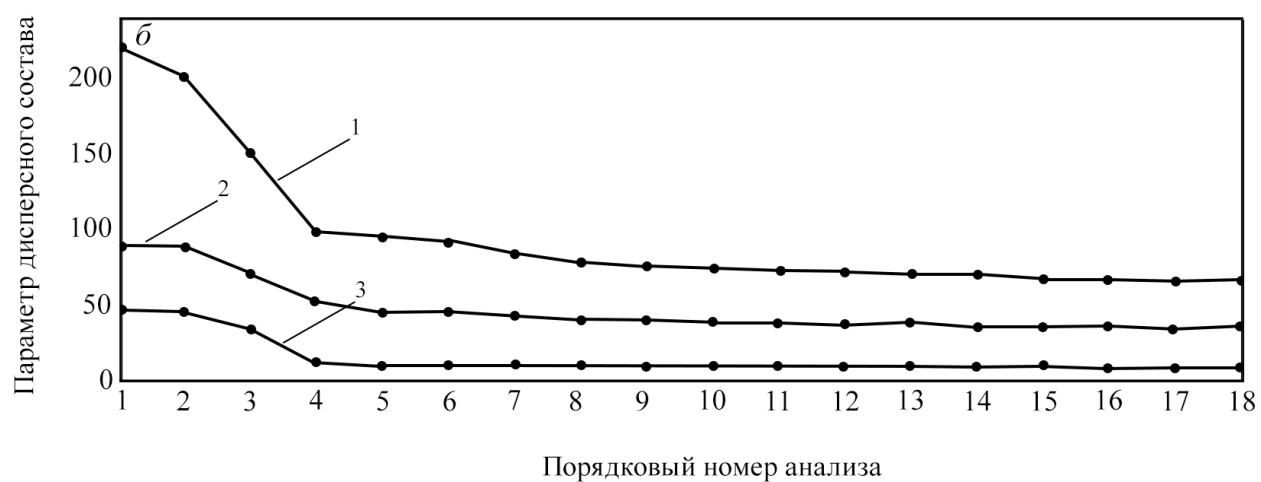
Рисунок 49 – Тренд влияния ультразвуковой обработки на параметры дисперсного состава образцов Al_2O_3-900 (а) и Al_2O_3-1100 (б). (1) – d(0.9) , (2) – d(0.5) , (3) – d(0.1) .
